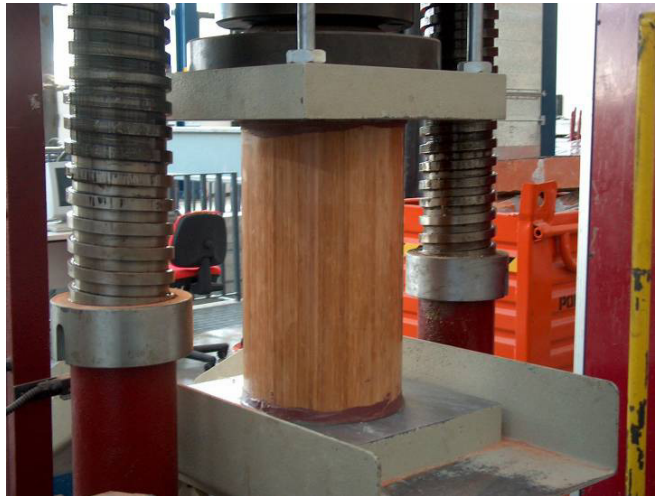
Prove di buckling
